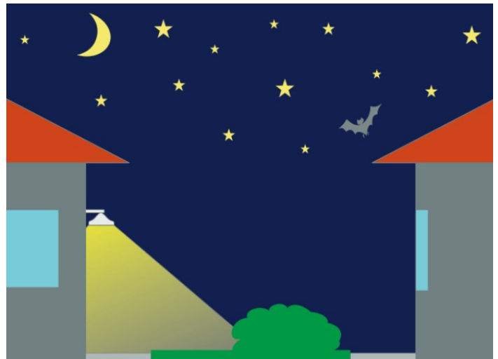
Příklad správně cloněného svítidla. Zdroj: svetelneznecistení.cz
